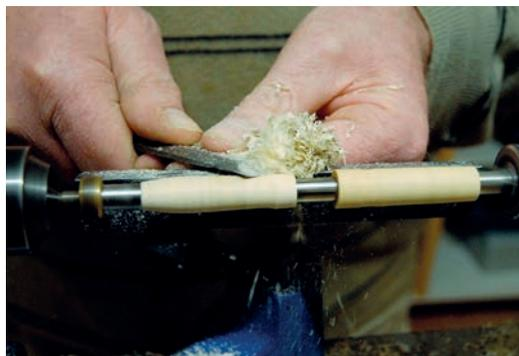
*Hier wird die endgültige Form eines Füllfederhalters aus Holz per Hand gedrechselt.*
