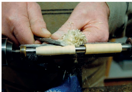
Hier wird die endgültige Form eines Füllfederhalters aus Holz per Hand gedrechselt.
